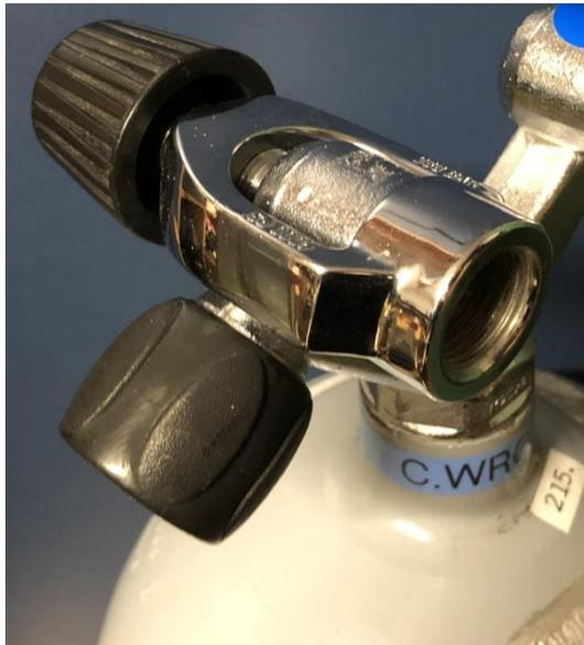
Bild: Flasche mit montiertem INT-Adapter
